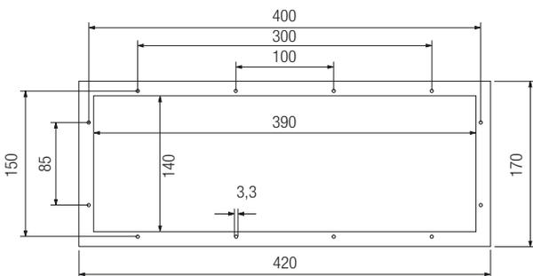
alle Bohrdurchmesser: 3,3 mm
